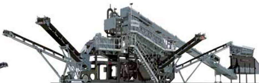
Aggresand – verarbeitet bis 400 t Kies zu Endprodukten
