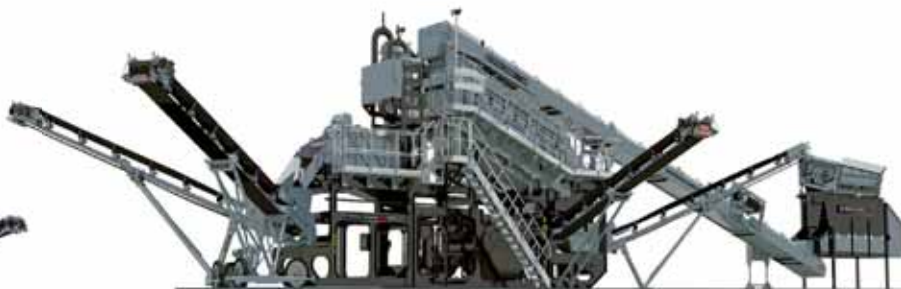
Aggresand – trasforma fino a un max di 400 t di ghiaia in prodotti finiti
