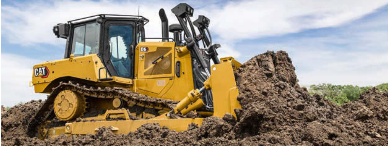
Innovation im Jahr 2019: der dieselelektrische Dozer D6 XE von Caterpillar.
