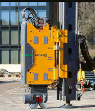
Das Schnellkupplungssystem ACS erlaubt das Wechseln der Anbaugeräte innert weniger Minuten.
