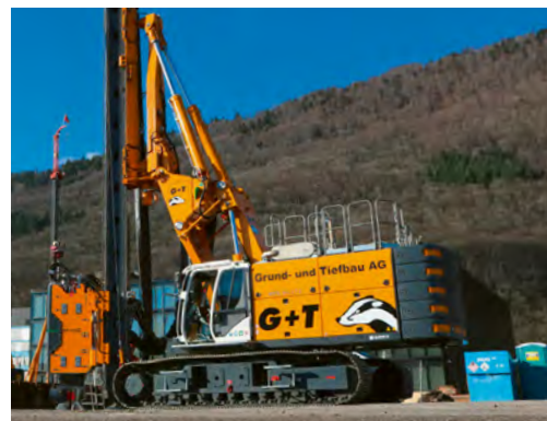
Trotz der 900 mm breiten Raupen betragen die Transportmasse der RG 27 S lediglich 3,4 m Breite, 3,6 m Höhe und 23 m Länge.
