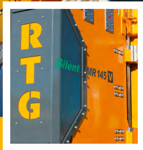
Le vibrofonneur est équipé du package Silent Vibro réduisant les nuisances acoustiques.
