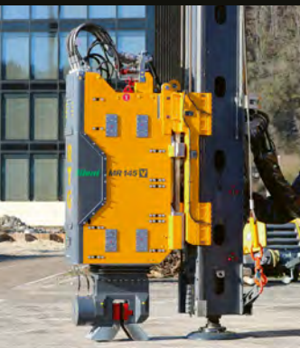
Le système de raccords rapides ACS permet de remplacer les accessoires rapportés en l'espace de quelques minutes.
