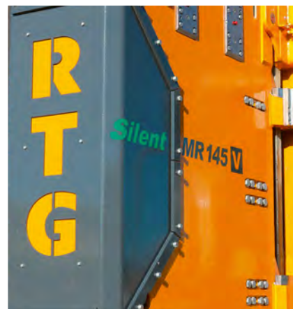
Il vibroinfissore è equipaggiato con il pacchetto Silent Vibro per ridurre le emissioni acustiche.
