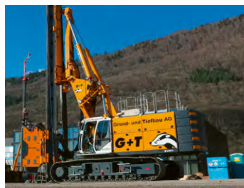
Nonostante i cingoli di 900 mm, le dimensioni di trasporto del RG 27 S arrivano a un massimo di 3,4 m di larghezza, di 3,6 m di altezza e di 23 m di lunghezza.
