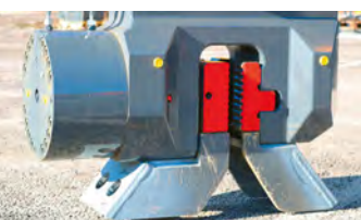
La RG 27 S può essere equipaggiata in via opzionale con una funzione che permette di sollevare le palanche in modo più semplice ed efficace.
