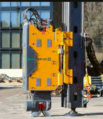
Il sistema di attacco rapido ACS permette di cambiare aggregati in pochi minuti.
