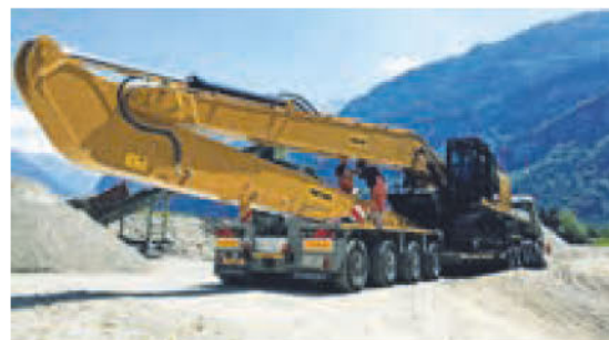
La Cat 349E LRE de 60 tonnes entièrement chargée sur la remorque surbaissée.
