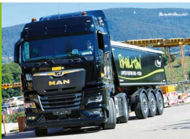
Der Stone Master light erreicht im Industrievergleich eine rund 40 cm tiefere Ladekante bei gleichem Ladevolumen u.a. durch die konische Muldenform und die optimierte Rahmenhöhe.
