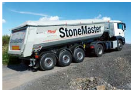
Der Stone Master light erreicht im Industrievergleich eine rund 40 cm tiefere Ladekante bei gleichem Ladevolumen u.a. durch die konische Muldenform und die optimierte Rahmenhöhe.
