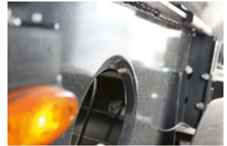
Gewichtsoptimiert und trotzdem stabil: Gebohrte und gepresste Aussparungen in Ringform erhalten die stabilisierende Wirkung des Stahlrahmens und verringern gleichzeitig das Gewicht.
