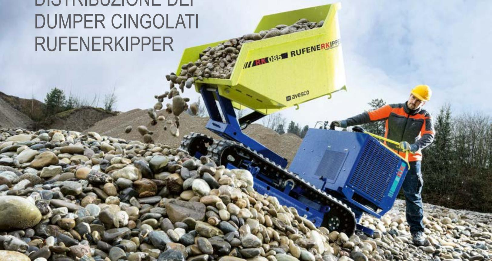
La trasmissione completamente idrostatica, installata di serie su tutti i modelli, garantisce un avanzamento confortevole e manovre sicure, anche in pendenza.
