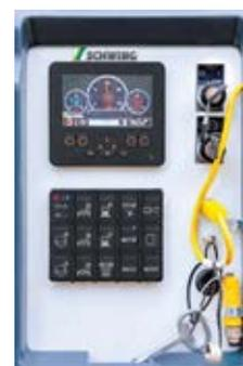
L'utilizzo e la manipolazione della TP 100 sono semplici e intuitivi, grazie alla struttura operativa chiara e al grande monitor a colori del sistema di controllo. I dati macchina, gli stati di esercizio e le impostazioni selezionati sono velocemente visualizzabili. Il sistema di diagnostica integrata indica all'operatore i necessari intervalli di manutenzione.
