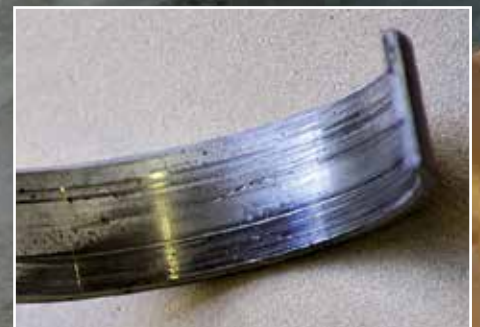
Überhöhter Verschleiss an Lagerschale
