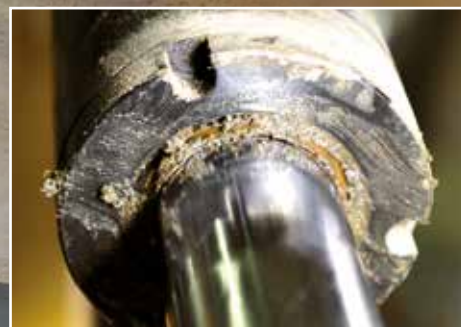
Source d'impuretés: les vérins
