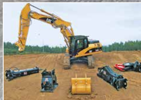
Source d'impuretés: le changement d'outils
