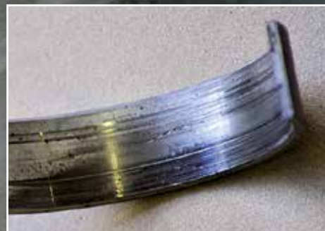
Usure prématurée des paliers
