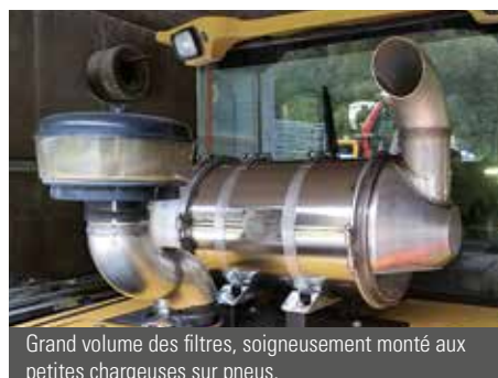
Triple installation sur Cat® 336 / 345, soigneusement intégrés. Installée pour un entretien extrêmement convivial.
