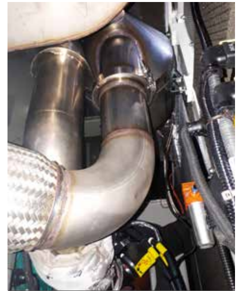
Conditions de place extrêmement restreintes. CAT d'oxydation unique, monté sur foreuse Klemm.
