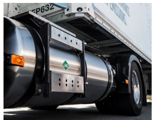
Camion avec réservoir de GNL (Photo: Volvo Truck Corporation)
