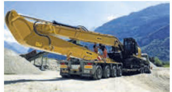
Der 60 Tonnen schwere Cat 349E LRE komplett verladen auf dem Tieflader.
