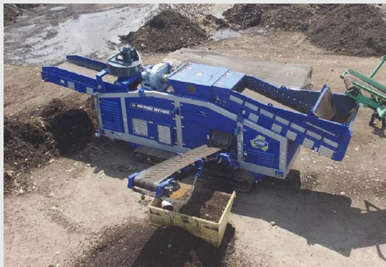
Edge MC1400: Triage de substances perturbatrices par processus en plusieurs étapes.
