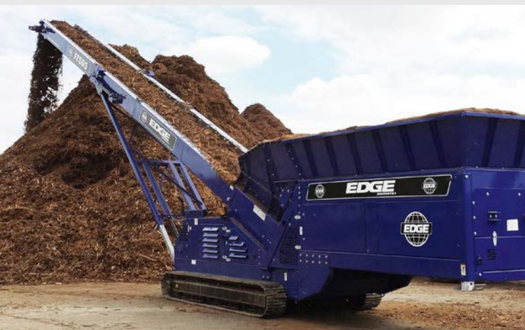
Edge FTS: Idéal pour le convoyage de matériaux en vrac avec une part de refus.
