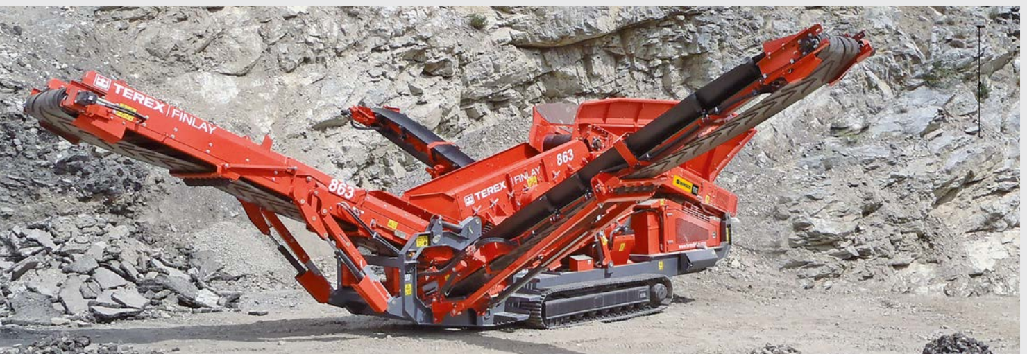
Série 8: Installation de criblage lourd pour la séparation de matériaux grossiers.
