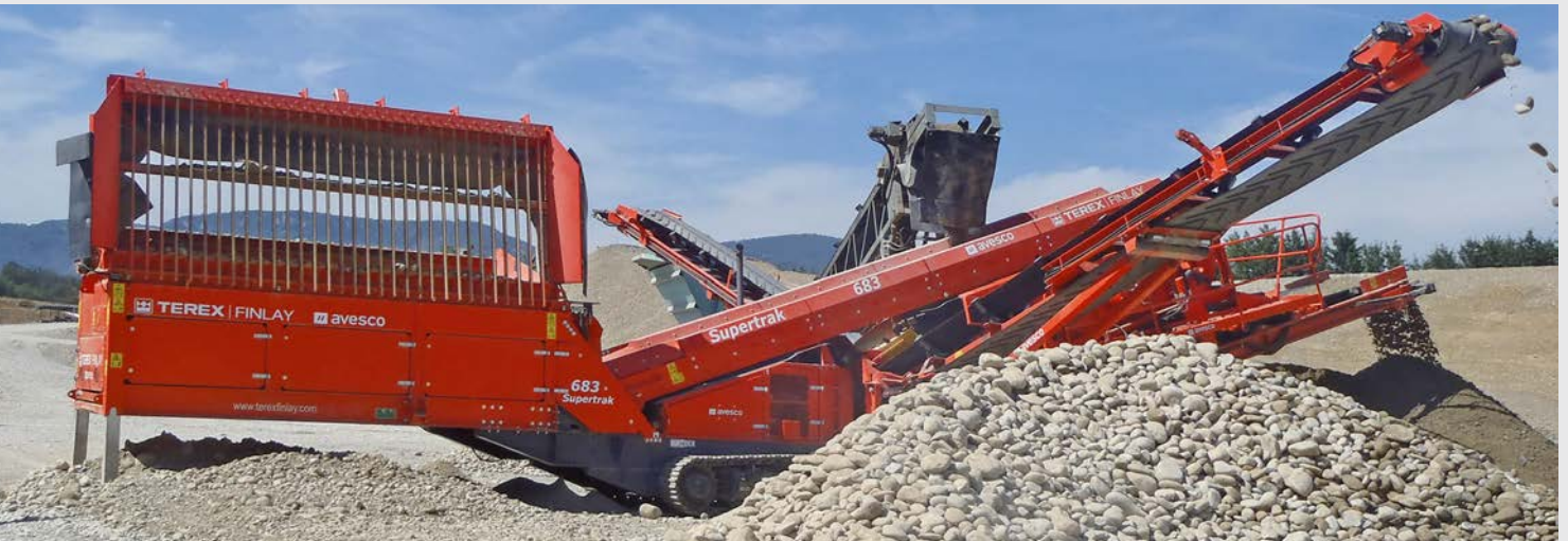
Série 6: Installations de criblage à 2 ou 3 étages pour la production de composants prêts à l'emploi
